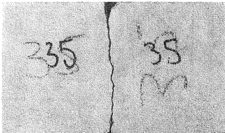
Rys. 17. Sposób pęknięcia próbek z wapienia miękkiego
